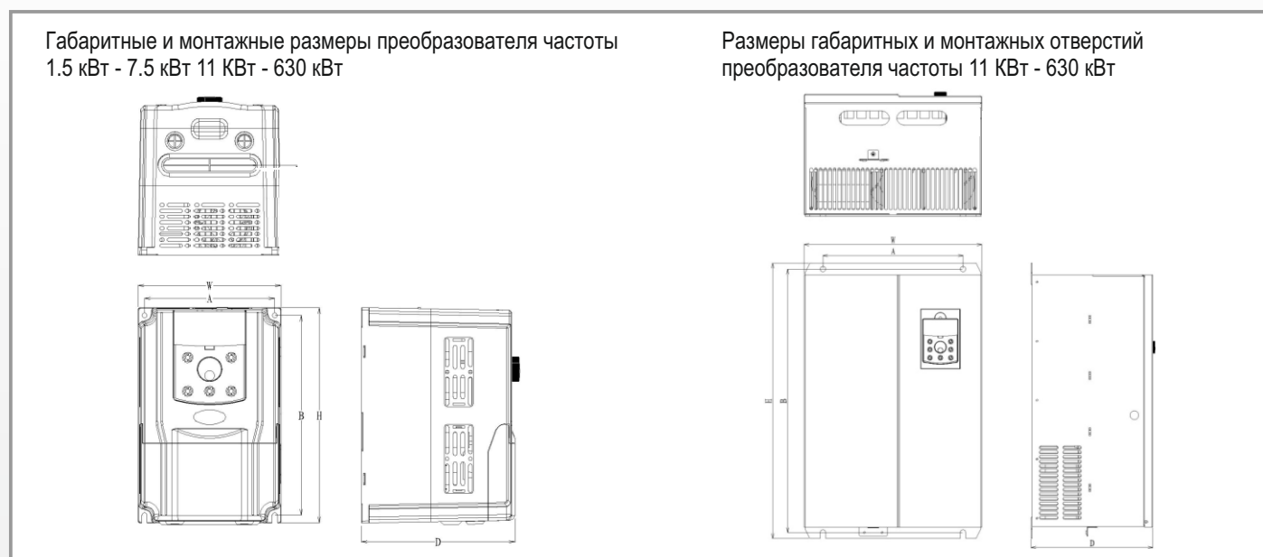
Габариты преобразователей частоты M420 и размеры монтажных отверстий (мм)
